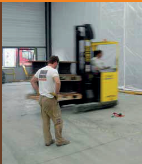
El comparador centesimal señala el movimiento de la losa al paso de la carretilla
