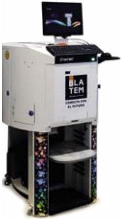
Máquina automática de 16 depósitos, con un nuevo sistema de doble válvula, que la hace más precisa a la hora de realizar los colores. Su sistema de recirculación de colorante fluye por las boquillas, por lo que no se secan, ni necesitan purgar habitualmente, para la buena conservación de las mismas. Dimensiones: 707 x 848x 1300. Puede albergar depósitos de 2.3 y 3,8 litros.
