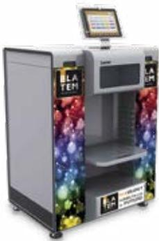
Santint AO200. Máquina automática de 16 depósitos. Realiza los colores más rápido, gracias a su sistema de dosificación simultánea de hasta 5 colorantes. Tiene un sistema de seguridad de presión, para evitar roturas en los conductos de colorante. Evita que se sequen las boquillas, con un sistema de humidificación, muy fácil de limpiar. Dimensiones: 880x775x1185. Capacidad de los depósitos: 2.5 y 4.5 litros.
